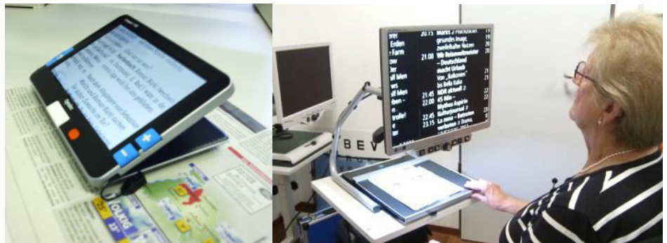
Vergrößernde Sehhilfen: Links eine elektronische Leselupe. Rechts ein Bildschirmlesegerät.
