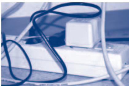
**SCHALTBARE STECKDOSENLEISTEN SORGEN FÜR EINEN SICHEREN ARBEITSPLATZ, ALLERDINGS SOLLTEN SIE NICHT ÜBERLADEN WERDEN**
