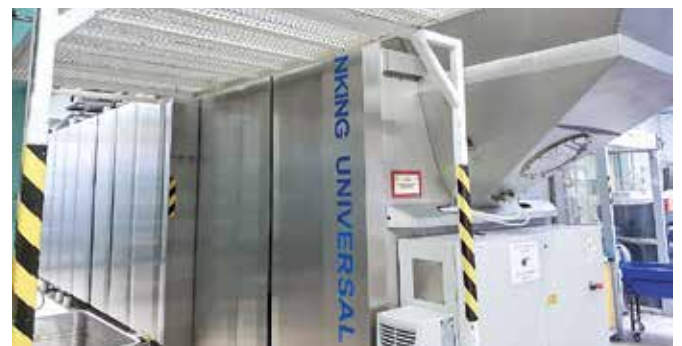
So lang wie eine Rangierlokomotive: Zehn Waschkammern umfassen die 14 Meter langen Waschstraßen der Uniklinik-Wäscherei.
