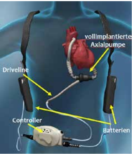
Abb. 2: Schema eines implantierten Linksherzunterstützungssystems vom Typ Heartmate II mit Driveline zum außerhalb des Körpers liegenden Controllers und den beiden Lithium-Ionen-Batterien.
