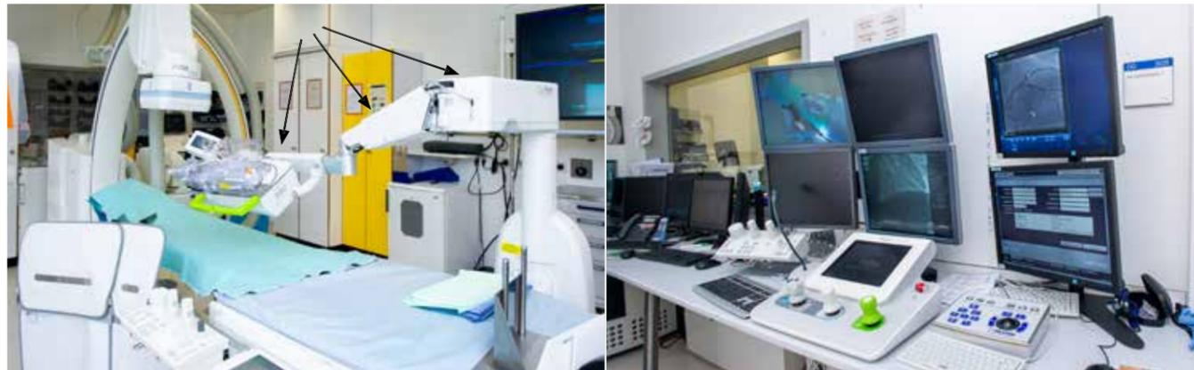
Abb. 1: A: Herzkatheteranlage mit Roboterarm (Pfeil); B: Roboter-Steuerkonsole im Kontrollraum
